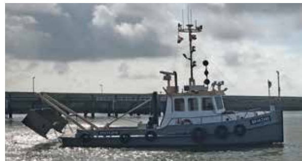
Altijd ruimte geven aan baggerschepen in de haven. Het zwarte bol-ruit-bol daglichtteken op de stuurhut betekent beperkt manoeuvreerbaar en dat voert de ploegboot ook.
