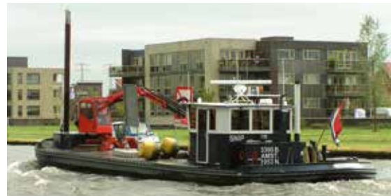
Een drijvend werktuig is een schip voorzien van werktuigen, die zijn bestemd om op vaarwegen of in havens te worden gebruikt.
