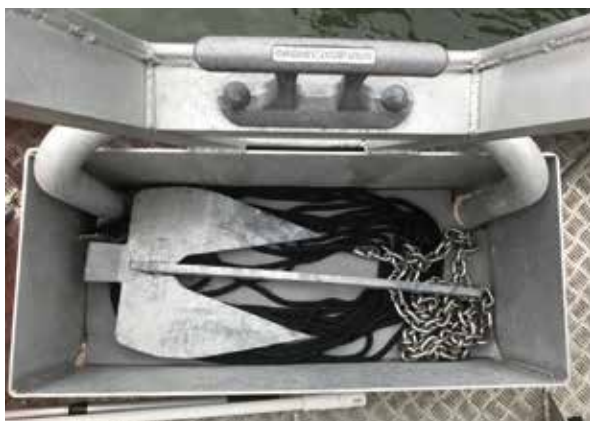
In de ankerbak een Brittany anker en 25 m loodlijn.
