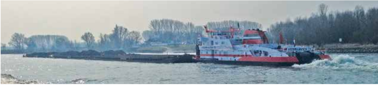
Een duwstel bestaande uit een duwboot en duwbakken.
