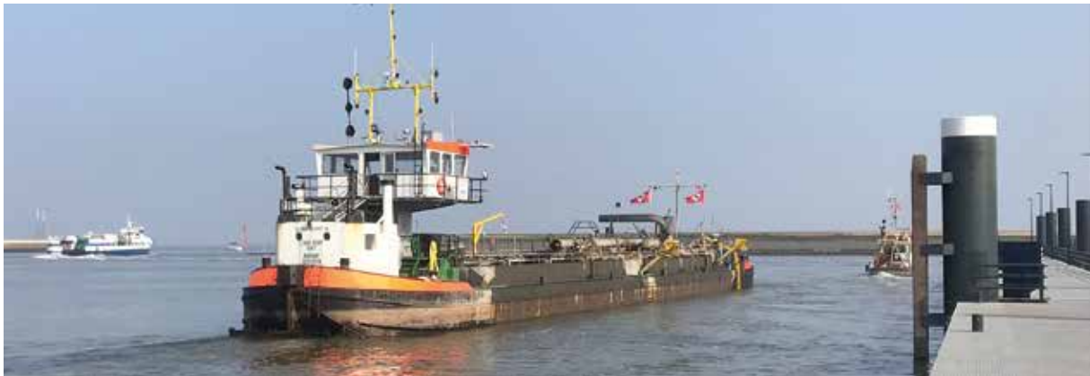
Altijd ruimte geven aan baggerschepen in de haven. Het zwarte bol-ruit-bol daglichtteken op de stuurhut betekent beperkt manoeuvreerbaar en dat voert de ploegboot ook.
