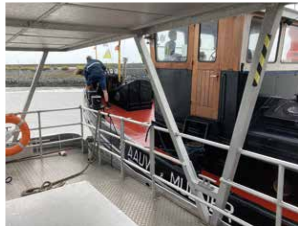
Een 60 tons sleepboot is alleen langszij te nemen bij weinig wind als het echt noodzakelijk is en over een kort stukje.
