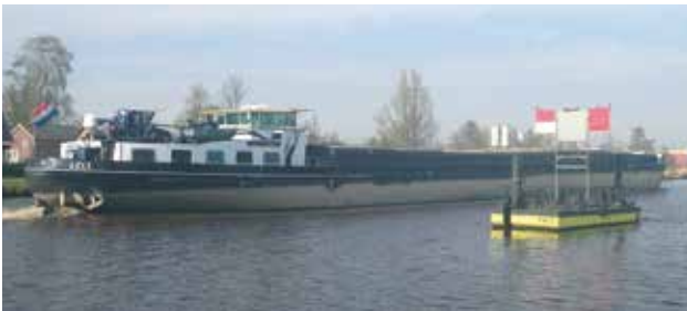
Een drijvend voorwerp is b.v. een ponton die het vaarwater markeert. Passeren aan de kant met het roodwitte teken, niet aan de kant met het rode teken.
