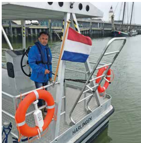
De MOB-ladder aan de achtersteven.
